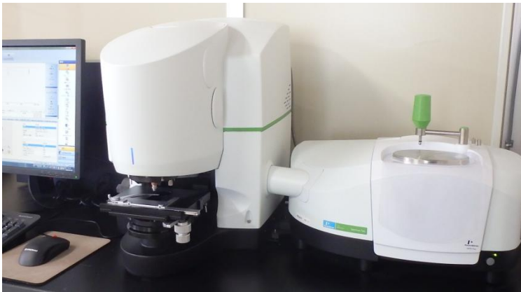
■ フーリエ変換赤外分光分析装置 (FT-IR) パーキンエルマージャパン 『Spectrum Two』 and 『Spotlight 150i』
